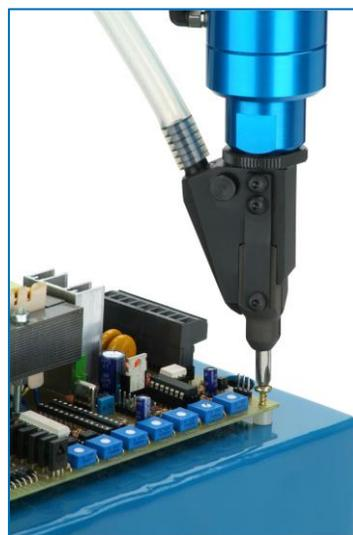
O sistema possui alimentador vibratório e cabeçote selecionador que posiciona e libera automaticamente um parafuso de cada vez ao final de cada ciclo.
