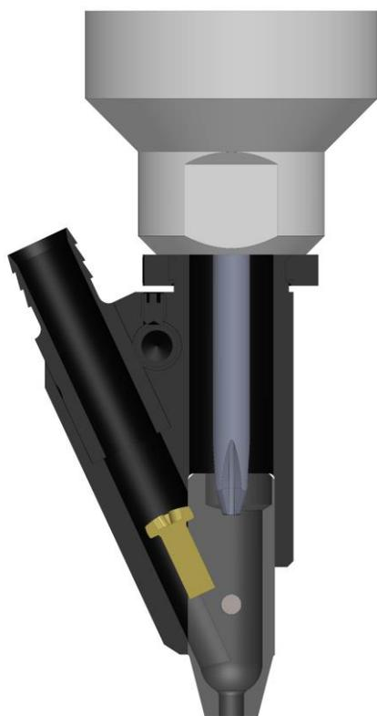
A unidade da câmara ejetora e parafusamento, consiste em um sistema de pinça axial bipartida.
