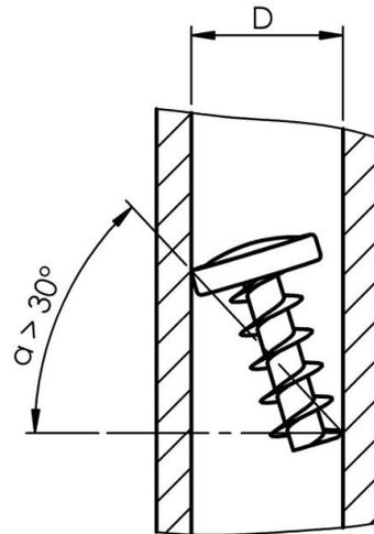
Para um melhor funcionamento do equipamento, o ângulo de contato do parafuso na mangueira deve ser superior a 30°.
